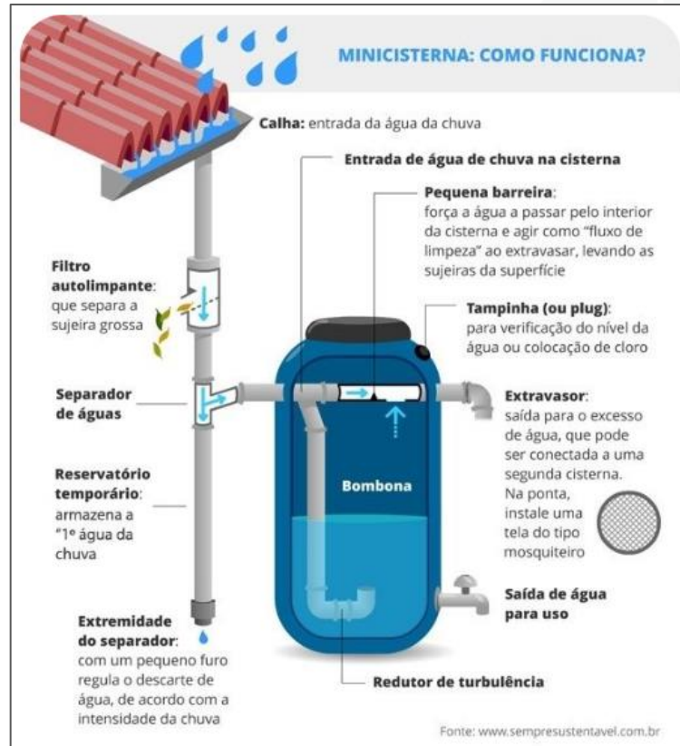
Figura 29: Modelo de cisterna para captação de água pluvial.
