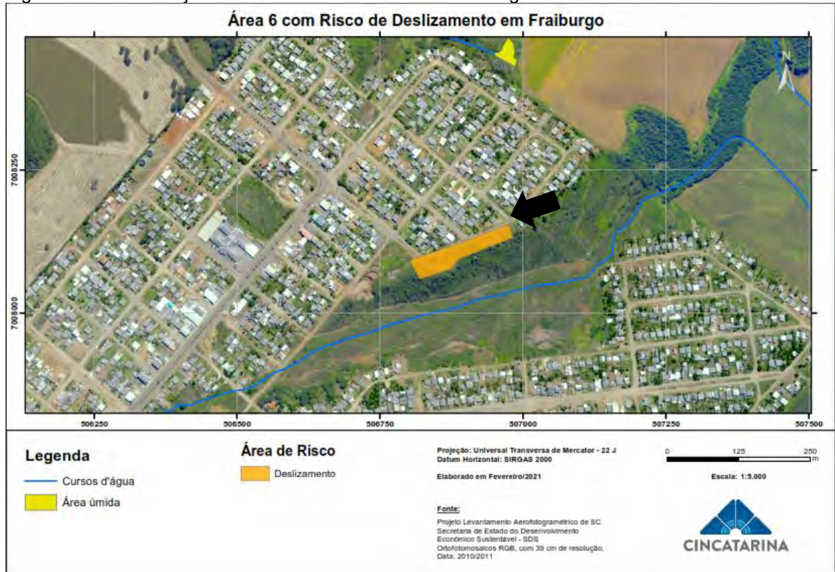
Figura 228: Área 6 sujeita à movimento de massa em Fraiburgo.
