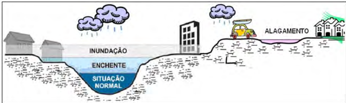
Figura 201: Representação de situação de enchente, inundação e alagamento.
