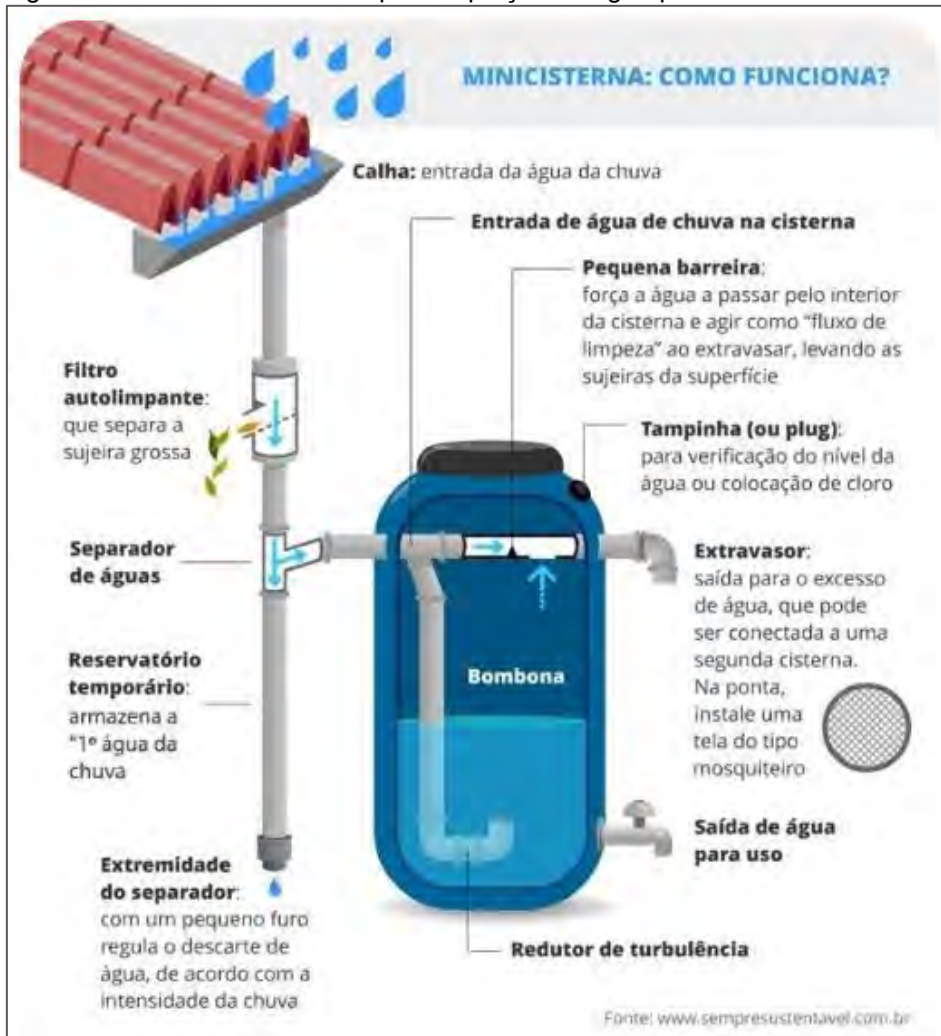
Figura 333: Modelo de cisterna para captação de água pluvial.
