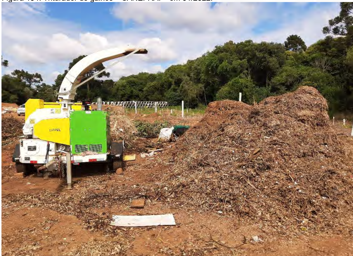
Figura 194: Triturador de galhos – SANEFRAI – em 01/2022.
