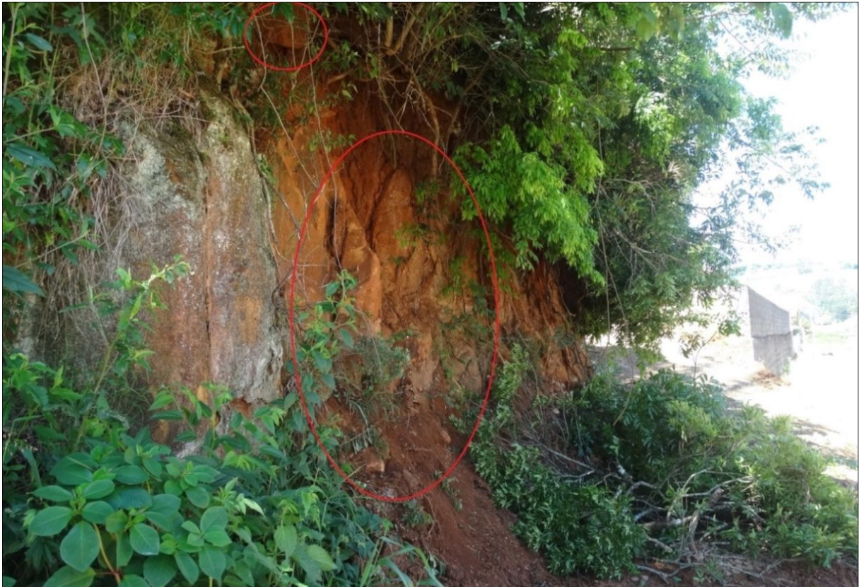
Figura 32 - Blocos e lascas soltas no substrato rochoso.
