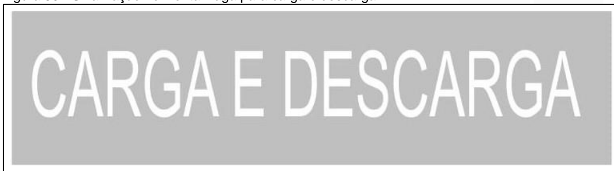
Figura 50 - Sinalização horizontal vaga para carga e descarga
